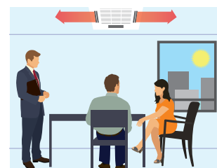
Indirektni protok zraka u slučaju prepoznavanja pokreta.
